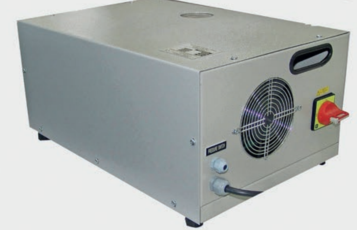
2SF10 10 litre dakika 140 bar Cat pompa 400 V 42 Kg Opsiyon: Kumanda dolabı / Zamanlayıcı Basınç şalteri / Otomatik boşaltma
