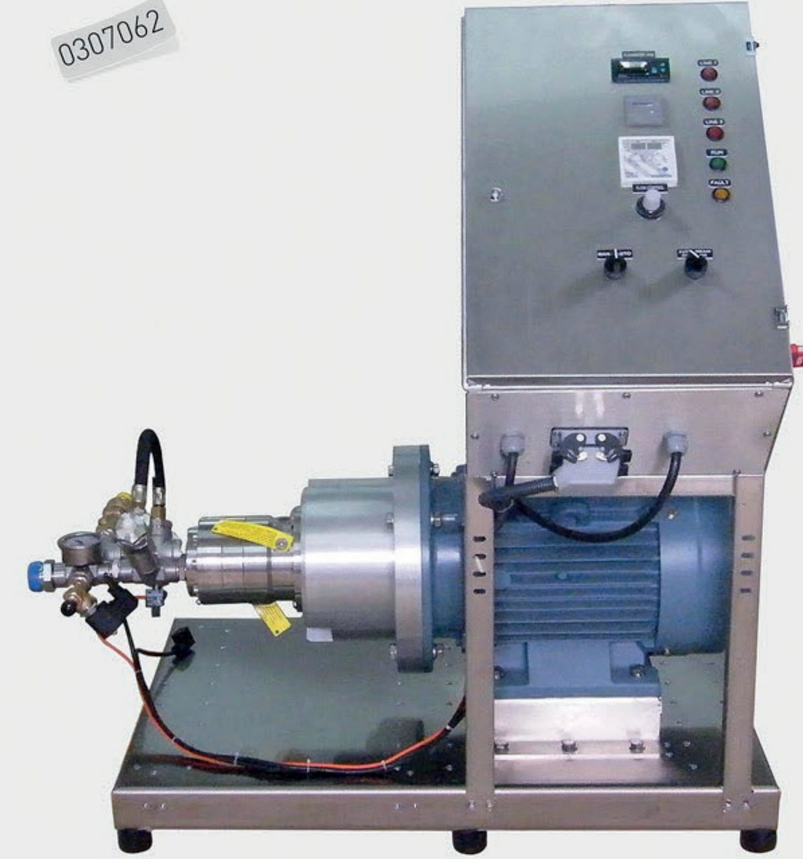
Frekans kontrollü DFP32 29 ve 73 litre dakika 100 bar 400 V 266 Kg Paslanmaz çelik kasa Kumanda dolabı / Zamanlayıcı Basınç şalteri / Otomatik boşaltma
