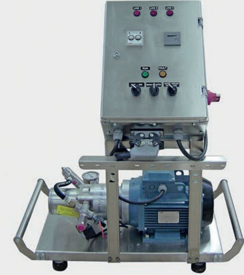
DFP10-13 13 litre dakika 100 bar Danfoss 400V 61 Kg Paslanmaz çelik kasa Kumanda dolabı / Zamanlayıcı Basınç şalteri / Otomatik boşaltma
