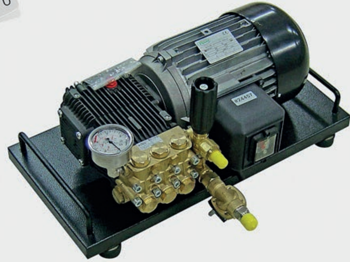
AR15 15 litre dakika 120 bar A.R. Pompa 400 V 39 Kg Opsiyon: Kumanda dolabı / Zamanlayıcı Basınç şalteri / Otomatik boşaltma
