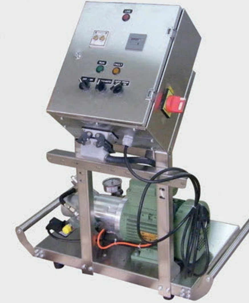
DFP2-2 2 litre dakika 100 bar Danfoss 230V 46 Kg Paslanmaz çelik kasa Kumanda dolabı / Zamanlayıcı Basınç şalteri / Otomatik boşaltma
