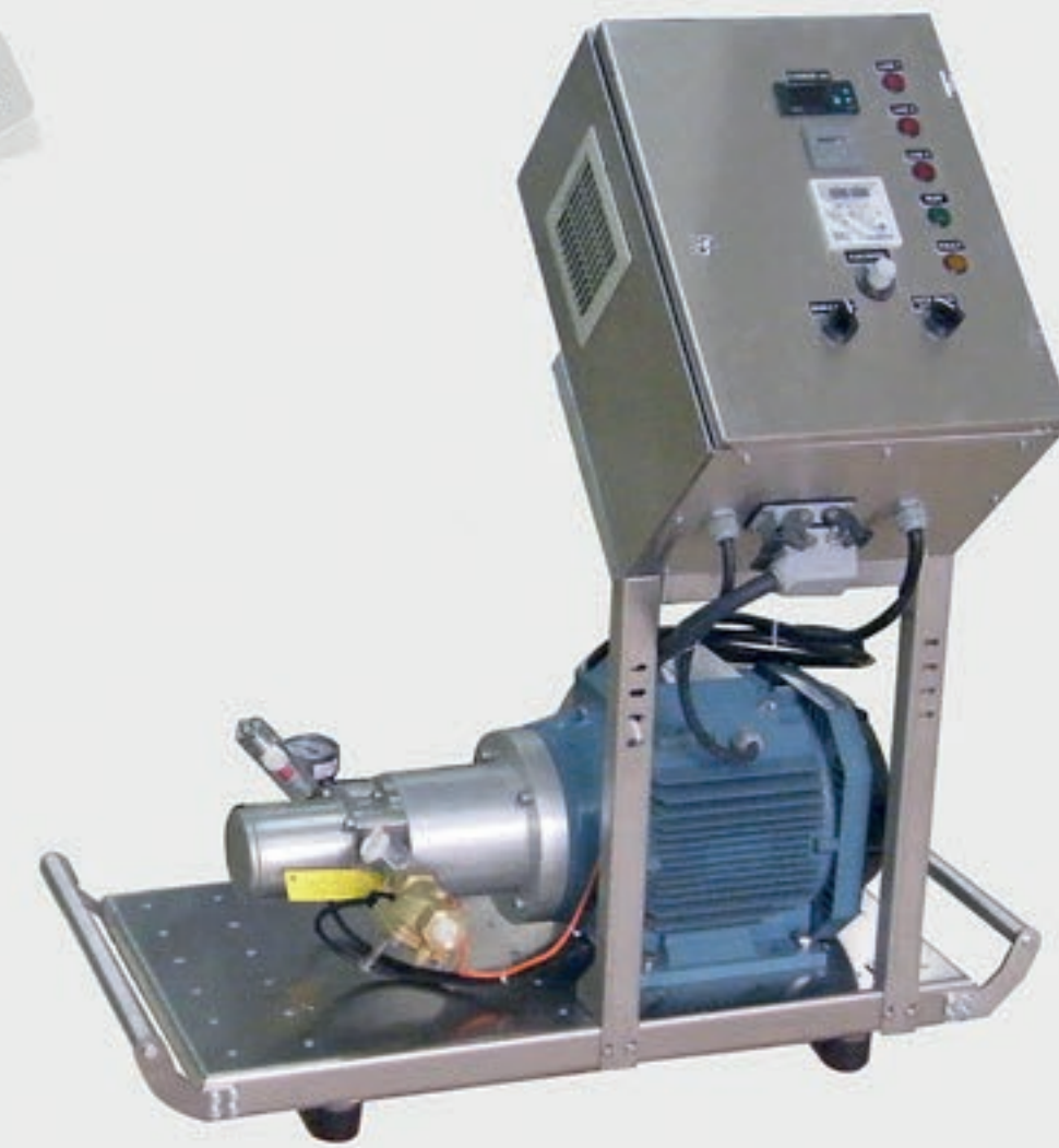
Frekans kontrollü DFP25 21 ve 56 litre dakika 100 bar Danfoss Pompa 400 V 231 Kg Paslanmaz çelik kasa Kumanda dolabı / Zamanlayıcı Basınç şalteri / Otomatik boşaltma
