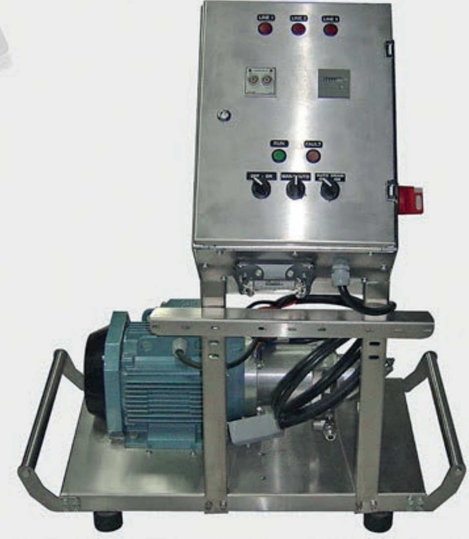
DFP6.3-8 8 litre dakika 100 bar Danfoss 230 V 54 Kg Paslanmaz çelik kasa Kumanda dolabı / Zamanlayıcı Basınç şalteri / Otomatik boşaltma
