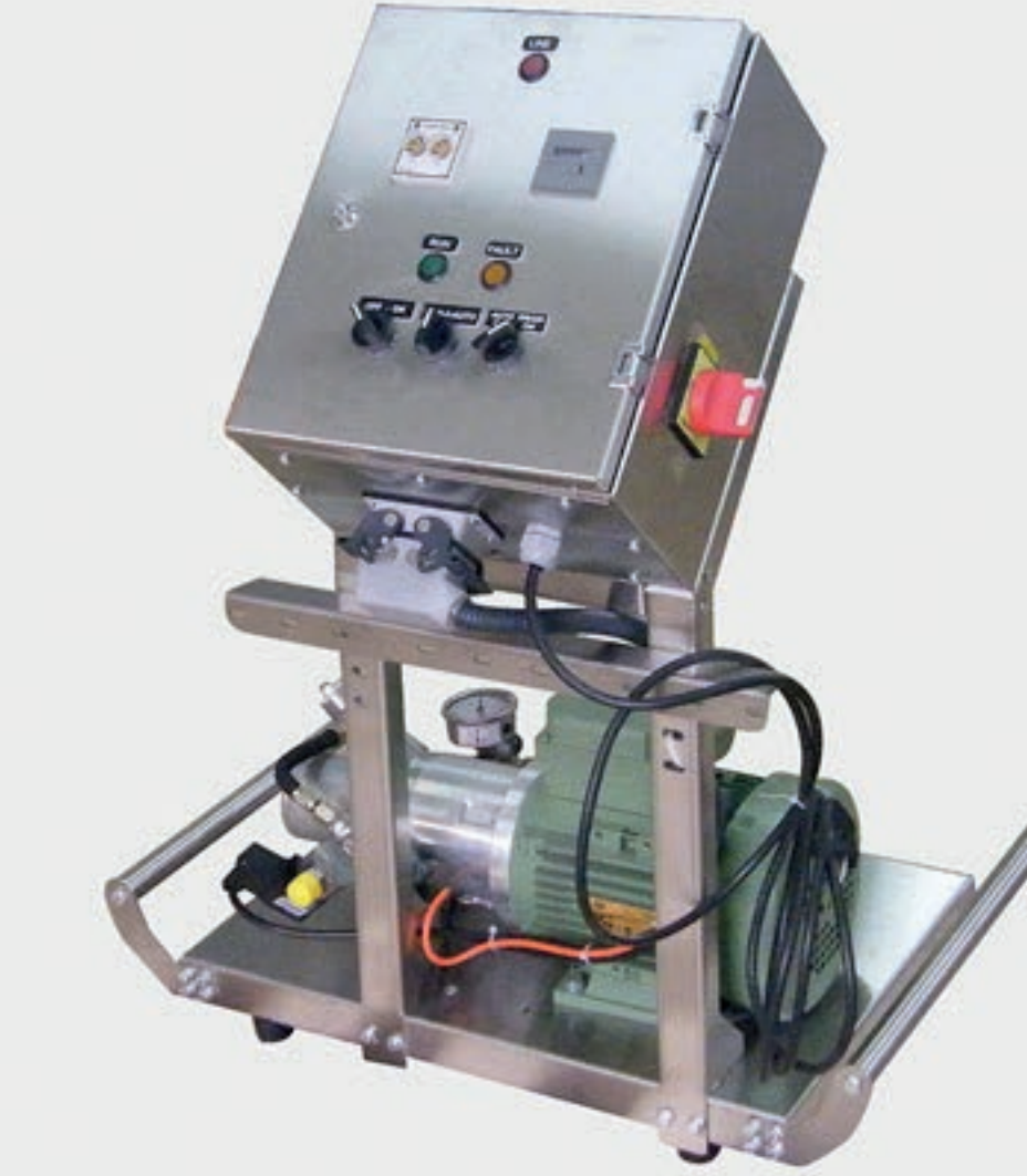
Frekans kontrollü DFP2-115 1 ve 5 litre dakika 100 bar 230 V 41 Kg Paslanmaz çelik kasa Kumanda dolabı / Zamanlayıcı Basınç şalteri / Otomatik boşaltma
