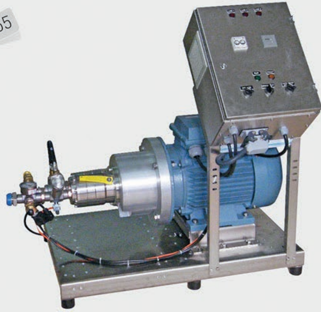
DFP32-45 45 litre dakika 100 bar Danfoss 400 V 215 Kg Paslanmaz çelik kasa Kumanda dolabı / Zamanlayıcı Basınç şalteri / Otomatik boşaltma
